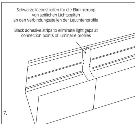
Schwarze Klebestreifen für die Eliminierung von seitlichen Lichtspalten an den Verbindungsstellen der Leuchtenprofile
